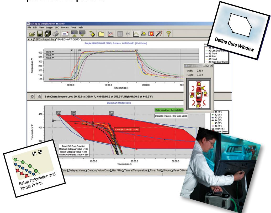
Ahora es fácil comparar sus datos de tiempo y temperatura con las especificaciones de la gráfica de horneado de su proveedor de pintura (ventana de curado). ¡De inmediato podrá ver si su proceso de curado está dentro de las especificaciones o no!
