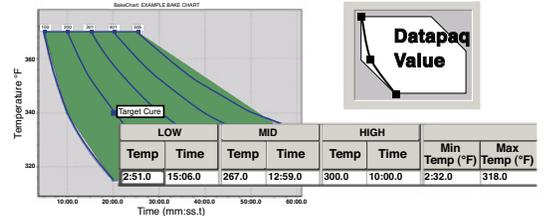
Reporte tiempo a temperatura para múltiples Paqfiles en un solo BakeChart de manera simultánea. Calcule y muestre gráficamente la media, datos de tiempo a temperatura y desviación de la media de perfiles/sondas actuales.
