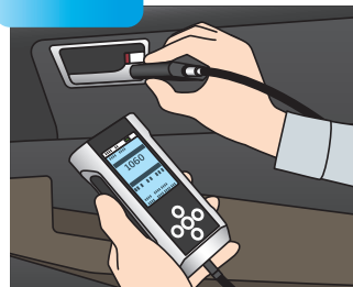
Analizadores de Apariencia Rhopoint IQ Flex20 Brillo, Haze Rhopoint IQ-S Brillo, Haze
